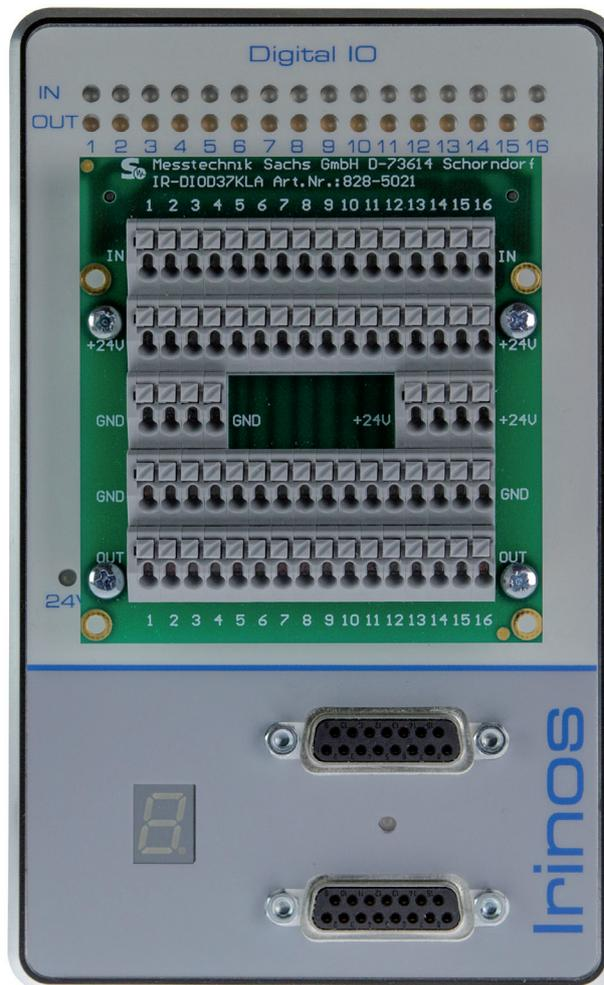
Ein optionaler Klemmenadapter ermöglicht den direkten Anschluss von Einzeladern an die Irinos-Box mit DSUB37-Steckverbinder. Der Adapter wird von außen aufgesetzt und mit vier Schrauben befestigt. Üblicherweise wird diese Variante in einem Schaltschrank eingesetzt.
