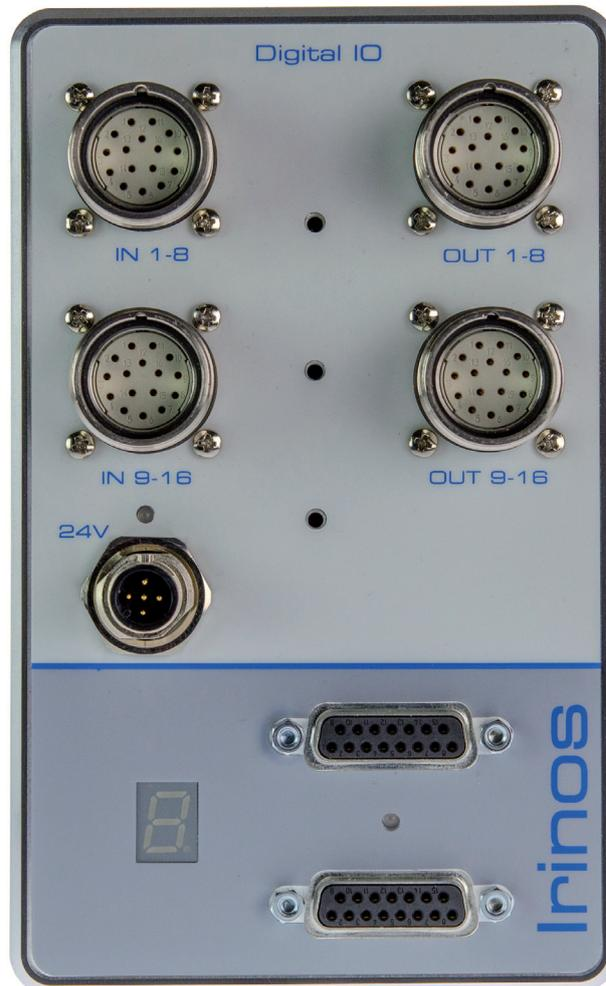
Die Variante mit M23-Steckverbindern eignet sich für den dezentralen E/A-Anschluss über Anschlussmodule. Diese sind von verschiedenen Herstellern verfügbar, z.B. MurrElektronik, Turck, Weidmüller, PhoenixContact, Erni, Escha.
