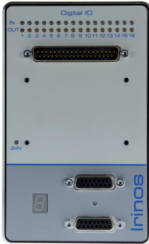
Bei der DSUB-Variante sind alle Ein-/Ausgänge sowie die separat zuzuführende Spannungsversorgung auf einem 37-poligen DSUB-Steckverbinder aufgelegt.
