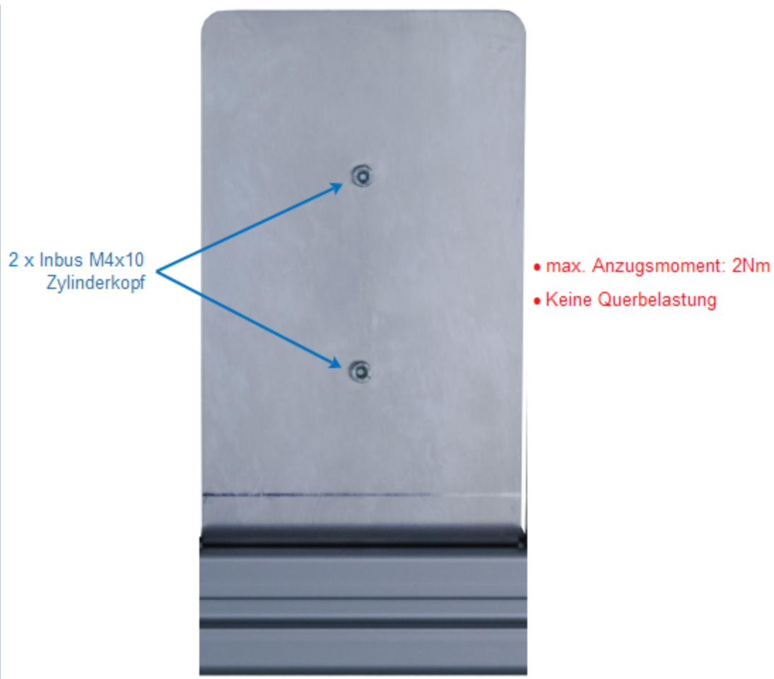
Montage der Irinos-Box am Befestigungswinkel
