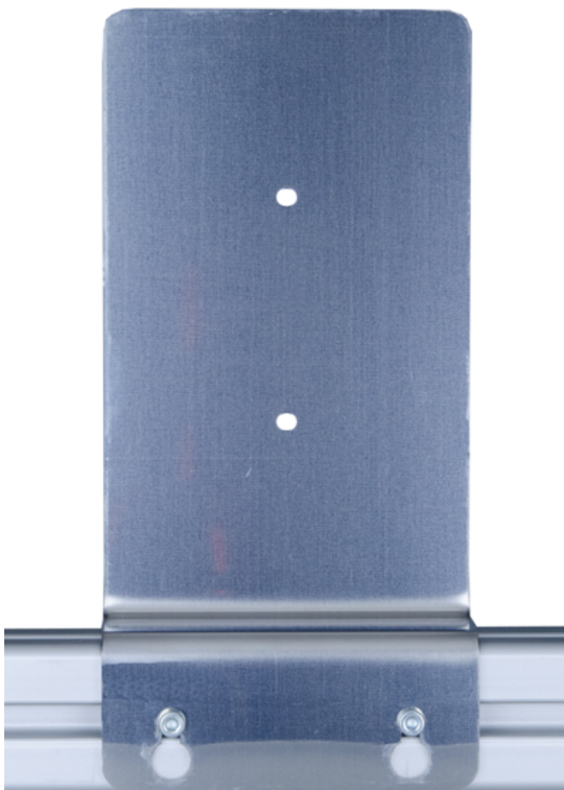
Montage des Befestigungswinkels am Item-Profil
